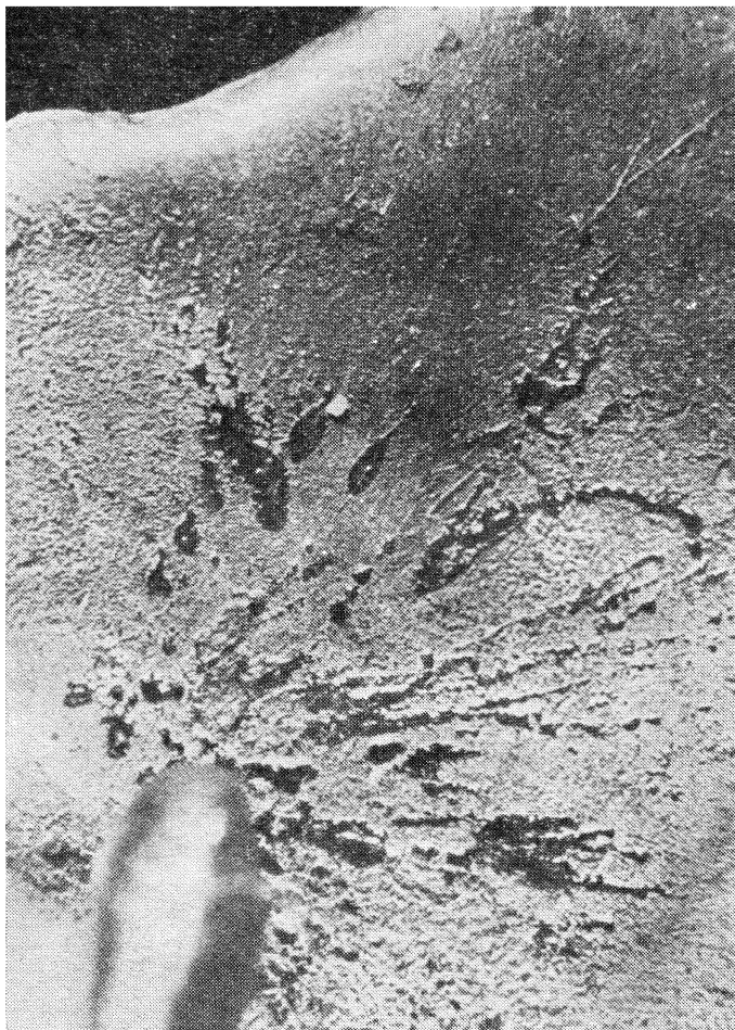
Рис. 46. Капли застывшего металла на поверхности одного из фрагментов Сихотэ-Алинского метеорита. Внизу виден выступ, с которого сдувались капли.
